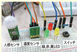
センサやLEDなどを配線した基板。プログラムによりこれらを制御します。
